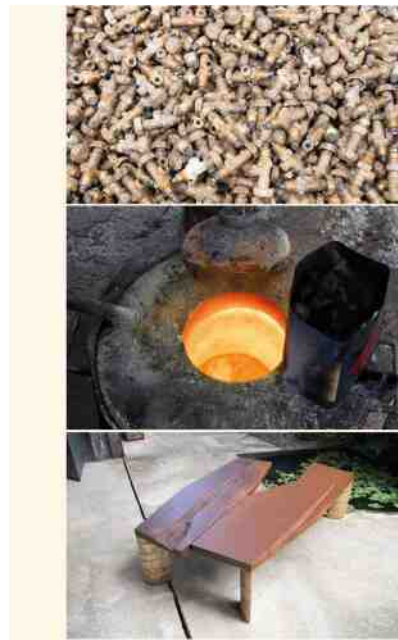
Fusion de robinets à l'aide d'un four et d'un chalumeau destinée à la création de nouvelles et objets design.
